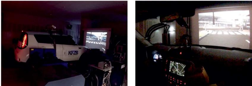
Bild 10: Interaktion zwischen Fahrzeug und VRU (Sicht am Prüfstand)
